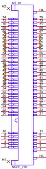
图 2-12 M.2 B-Key 示意图
