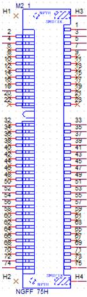
图 2-13 M.2 E-Key 接口示意图
