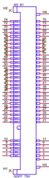
图 2-15 M.2 B-Key 示意图
