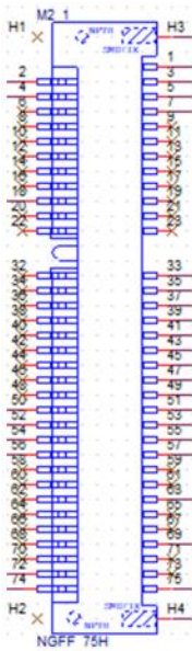
图 2-16 M.2 E-Key 接口示意图
