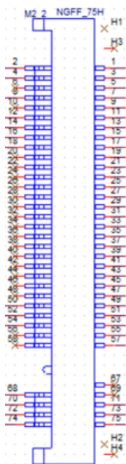
图 2-11 M.2 B-Key 示意图
