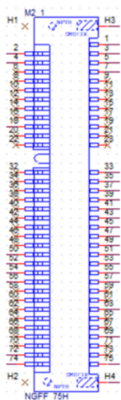
图 2-16 M.2 E-Key 接口示意图
