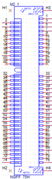
图 3-20 M.2 E-Key 接口示意图
