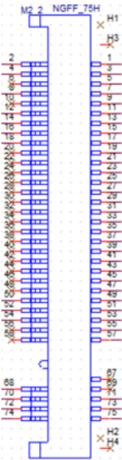
图 3-19 M.2 B-Key 接口示意图
