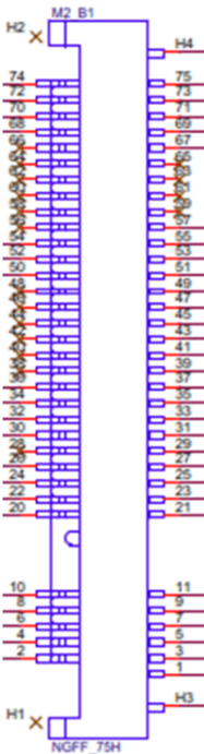
图 3-18 M.2 B-Key 接口示意图
